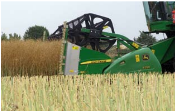
Rapsschneidwerk mit Seitenmesser und Tischverlängerung
